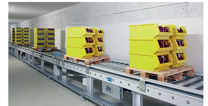
Vollautomatisches Förderband zwischen Lager und Produktion
